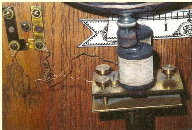
Obr. 1. (Vlevo) Detail hodin, kde byl pro synchronizaci hodinového kyvadla použit elektromagnet, ovládaný ze vzdálených hodin (hlavních)
