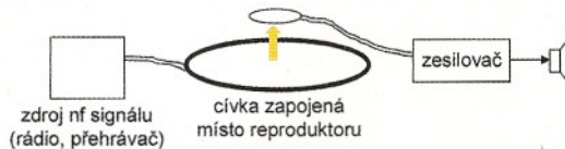
Obr. 8. Přenos nf signálu indukční vazbou
